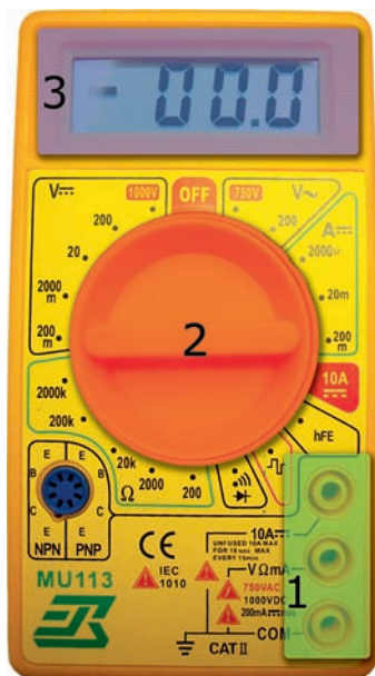
Abb. 1: Die 3 typischen Bereiche eines DMM. 1: Anschlussfeld, 2: Drehschalter, 3: Anzeige.
