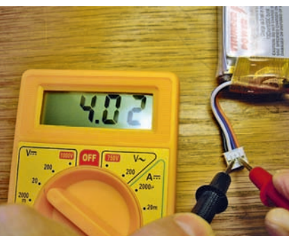
Abb. 4: Messen der einzelnen Zellspannungen am Balancing-Stecker. Die hier gemessene Zelle des 3s1p-Packs hat eine Spannung von 4,02 V.
