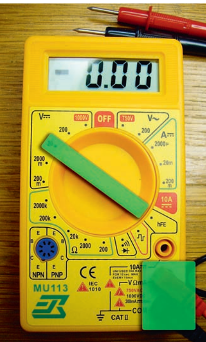
Abb. 3: Richtig konfiguriertes DMM für eine Spannungsmessung bis 20 V DC.
