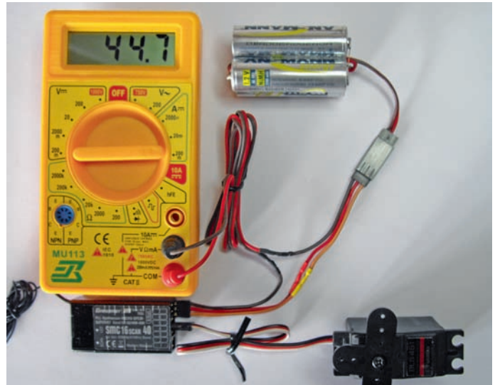
Abb. 2: Messung des Ruhestroms in der Empfangsanlage. Der angezeigte Wert beinhaltet auch den Ruhestrom des angeschlossenen, unbelasteten Servos.
